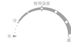
2、调节调温旋钮，冷藏室设定温度依次变化，档位从“关”调至“最冷”，共7个档位。用户在使用过程中可根据实际情况自行调节档位。
