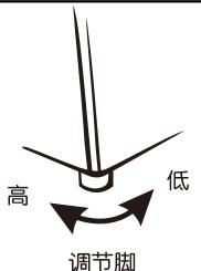
如果冰箱放置不稳定，将会产生振动和噪音，导致故障发生。另外如果安装在地毯、木地板或氯乙烯材料的地板上，冰箱散发出来的热量可能引起放置面变色，所以建议冰箱底下铺垫结实的板材。
